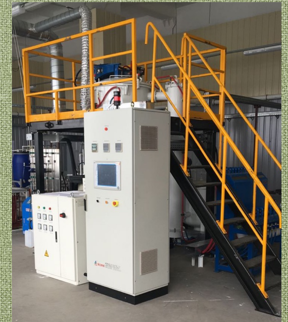
Установка CVD SiC (MTS)
