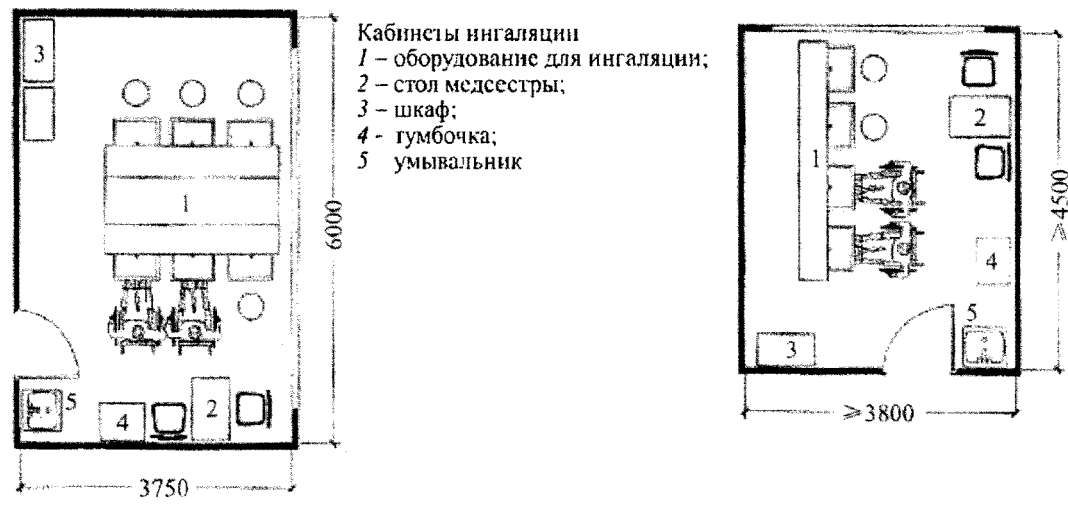
Рисунок Б.9. Примеры расстановки оборудования в помещениях поликлиник и амбулаторий
