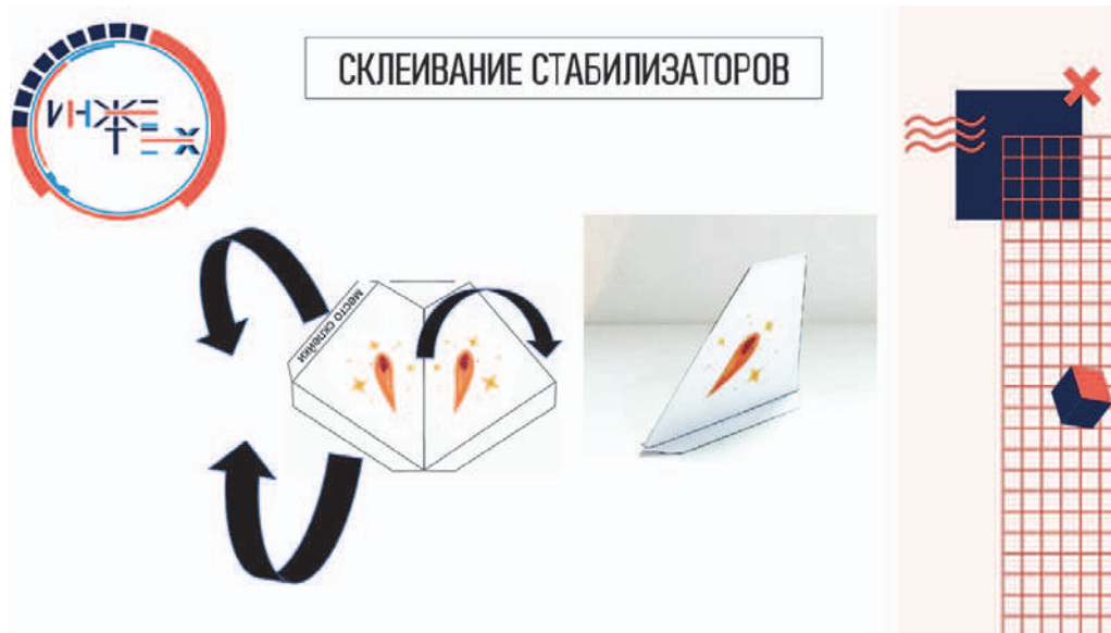
Рисунок 6 – Слайд из презентации на тему урока «Построение одноступенчатой модели ракеты без двигателя»
