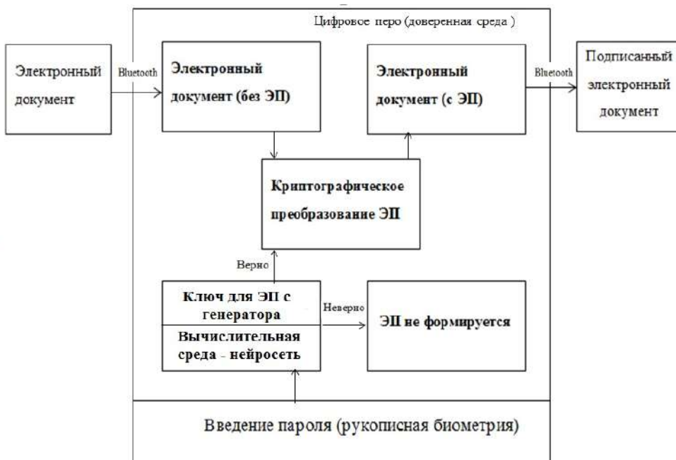
Рисунок 3 – Структурная блок схема «цифрового пера», осуществляющего формирование ЭП
