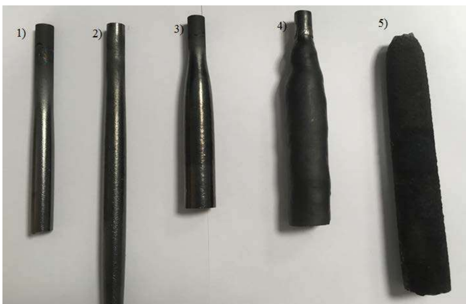
Рисунок 4 – Внешний вид карбидокремниевых образцов, полученных при различной температуре: 1- 720^{\circ}\text{C} , 2 – 820^{\circ}\text{C} , 3 – 920^{\circ}\text{C} , 4 – 1020^{\circ}\text{C} , 5 – 1120^{\circ}\text{C}
