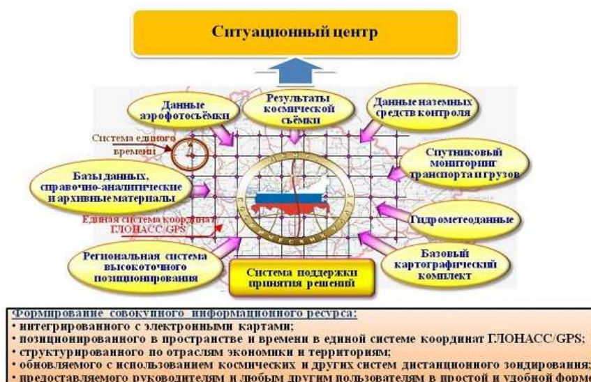
Рисунок 1 – Типовая схема ситуационного центра для космических исследований на базе центра обработки данных
