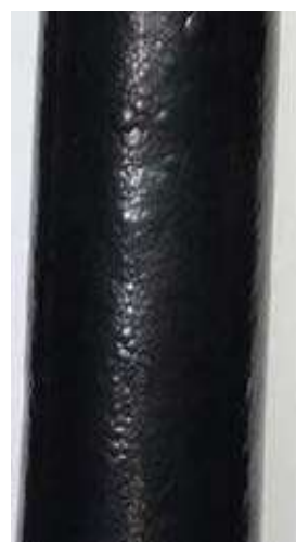
Рисунок 5 – Образец карбида кремния, полученный при T=920^{\circ}\text{C} , P=50\text{ Па} : а) микроструктура образца, б) поверхность образца
