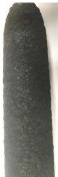
Рисунок 6 – Образец карбида кремния, полученный при T=1120^{\circ}\text{C} , P=50\text{ Па} : а) микроструктура образца, б) поверхность образца
