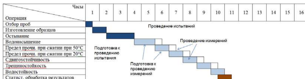
Рисунок 5 – Технологическая карта процесса испытания смеси при ускоренном методе испытаний образцов
