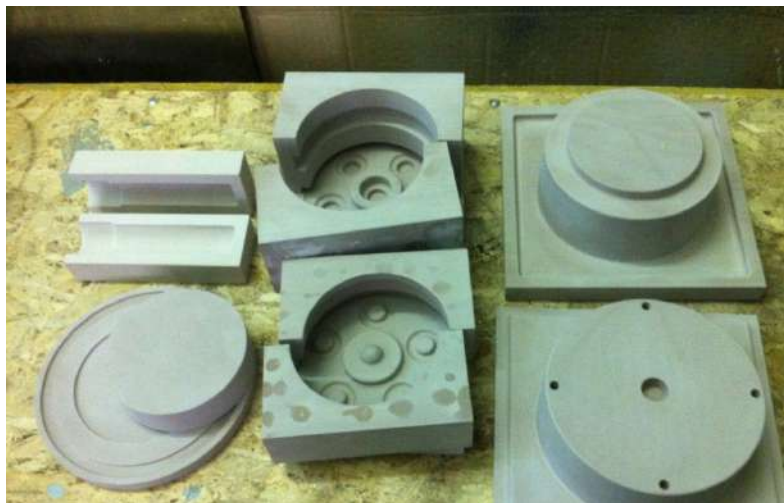
Рисунок 4 – Оснастка, изготовленная на 3D принтере
