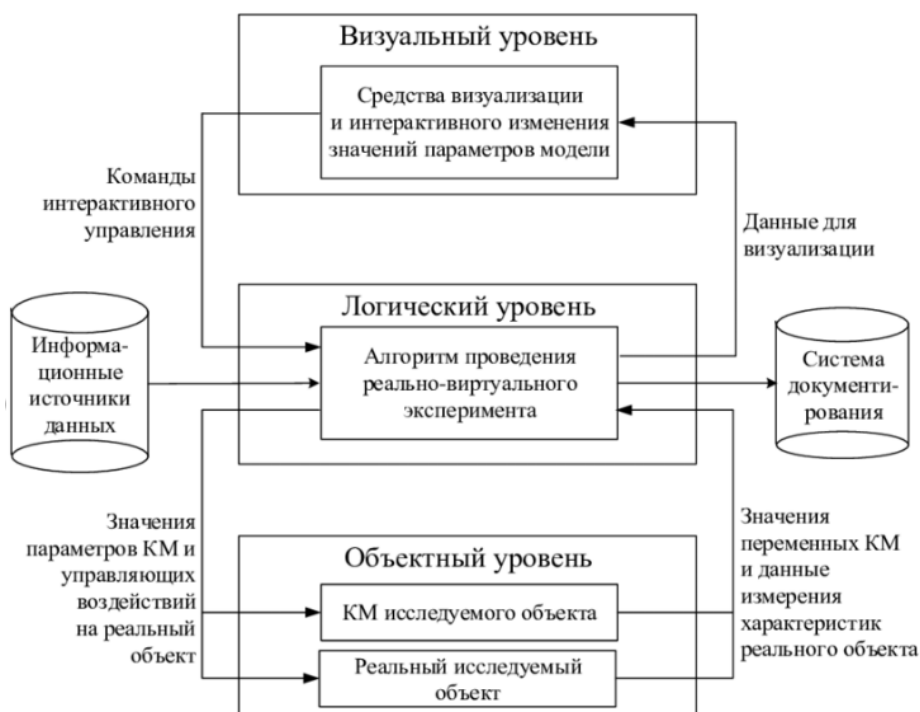
Рисунок 5 – Типовая структура многоуровневой компьютерной модели цифрового двойника изделия
