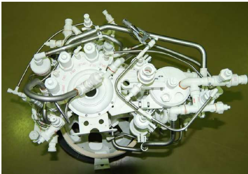
Рисунок 4 – Пример использования в 3D-макете из пластика металлических трубопроводов и крепежа для соединения отдельных узлов и агрегатов (ФГУП ГКНПЦ им. М. В. Хруничева и КБ химмаш им. А. М. Исаева)
