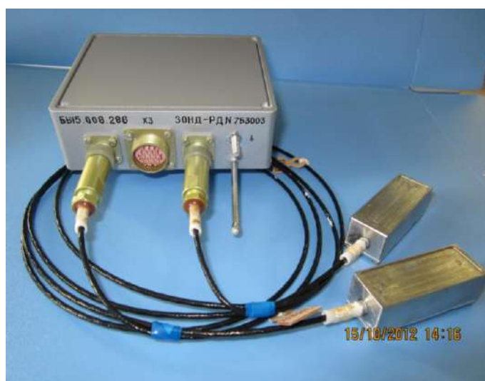
Рисунок 5 – Система «ЗОНД-РД» для контроля переменных магнитных полей ионизированных газовых потоков двигателей
