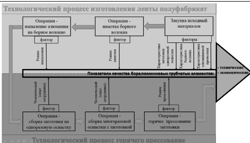
Рисунок – 1 Модель причинно-следственной связи показателей качества боралюминиевых трубчатых элементов от основных факторов технологического цикла производства
