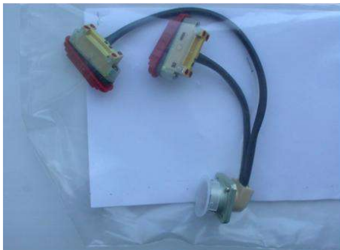
Рисунок 3 – Фотография макетного образца ЭРИ, изготовленного с использованием облегченного компаунда ЭЛК-М
