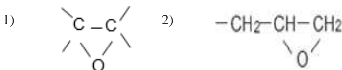
Рисунок 1 – Эпоксидная и глицидиловая группы эпоксидных соединений
