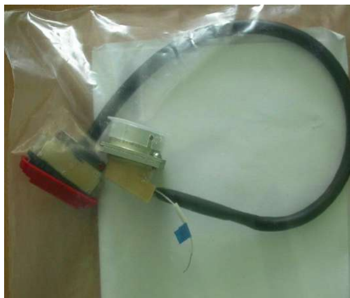
Рисунок 4 – Фотография макетного образца ЭРИ, изготовленного с использованием образца облегченного компаунда ЭЛК-М
