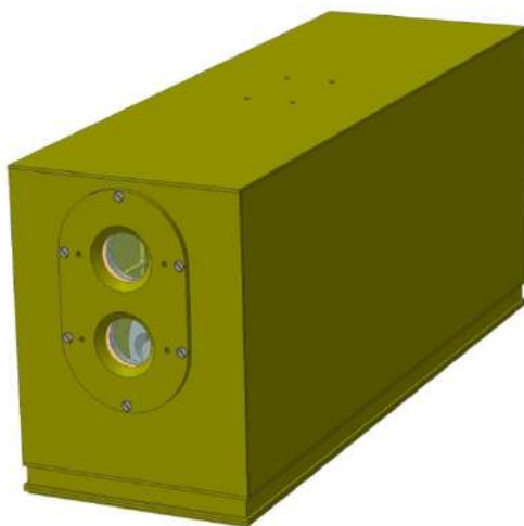
Рисунок 4 – Герметические коробки оптических приборов для контроля поверхности МКС УФ, ИК и видимом диапазоне спектра
