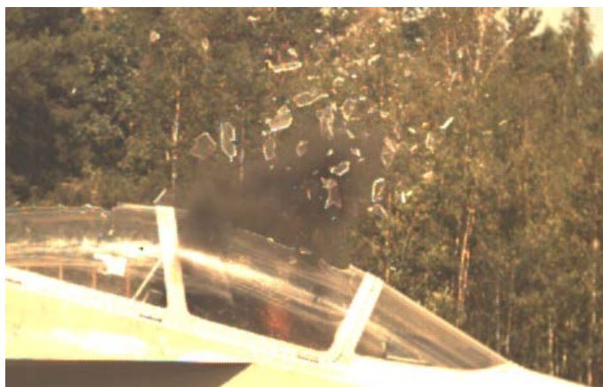
Рисунок 10 – Пример эксперимента по оценке избыточного давления, действующего на уши манекена при срабатывании СР-130
