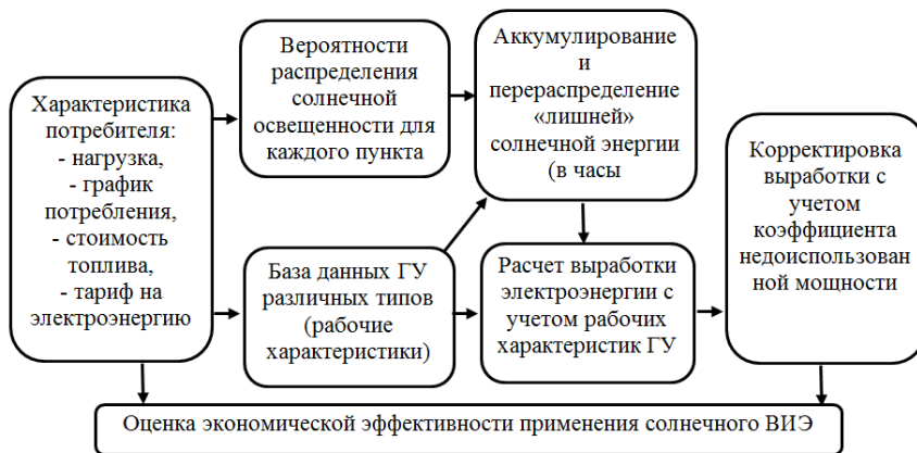
Рисунок 2 – Схема проведения исследований по оценке экономической эффективности применения солнечных установок
