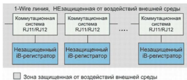
Рис. 3 - Подключение iB-регистраторов с помощью коммутационных систем RJ11/RJ12
