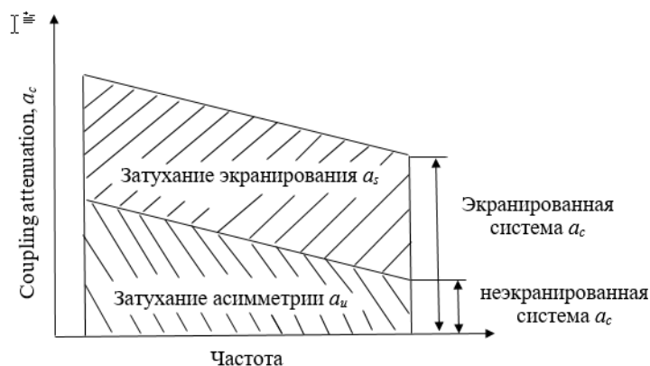
Рисунок 1. Эффект сложения затухания экранирования и затухания асимметрии
