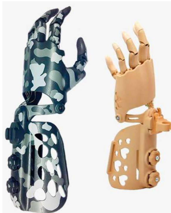
Рисунок 2 – Тяговый протез кисти руки фирмы Моторика
