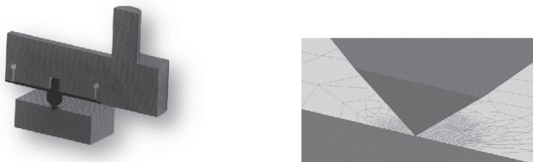
Рисунок 6 – Расчетная модель индентора и образца
