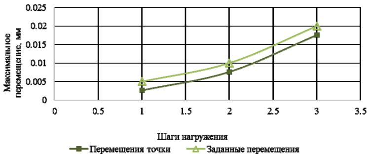
Рисунок 10 – Зависимость перемещения точки индентора в сравнении с заданным перемещением образца меди
