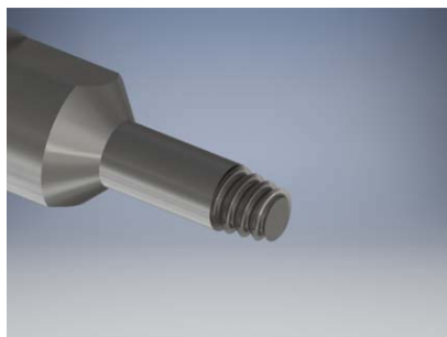
Рисунок 5 – Рабочая часть инструмента, применяемого для сварки трением с перемешиванием
