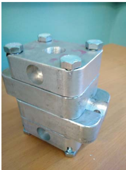
Рисунок 2 – Конструкция испытательных листов на разрыв
