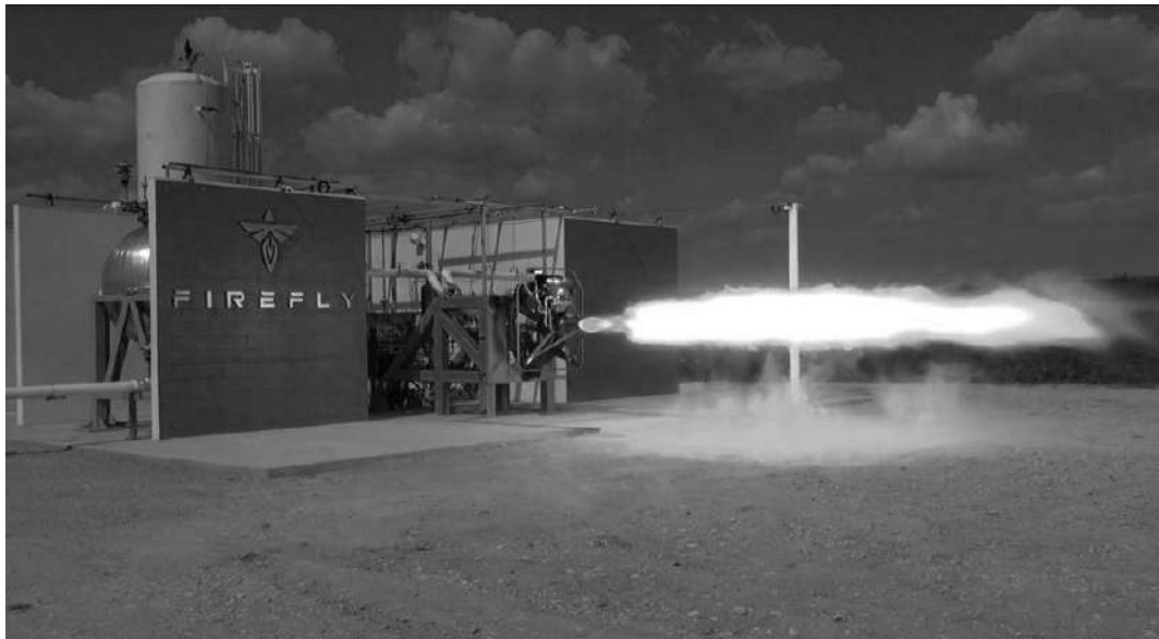
Рисунок 4 – Испытания двигателя FRE-R1 для второй ступени ракета-носителя Firefly Alpha
