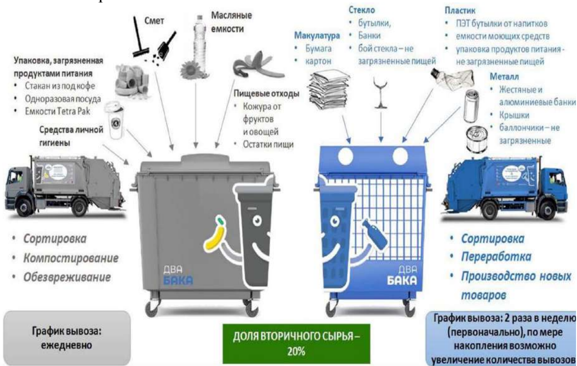
Рисунок 1 – Пример работы двух контейнерной системы сбора отходов в Московской области
