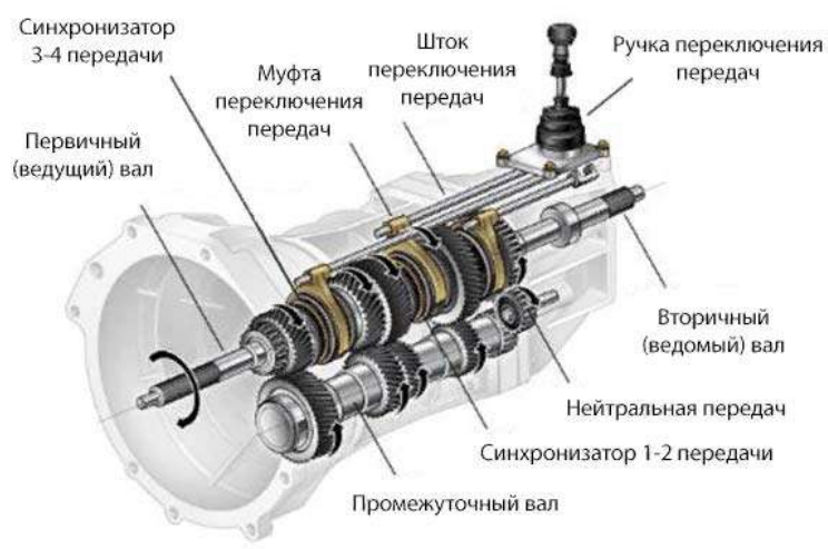
Рисунок 4 – Механическая пятиступенчатая коробка передач
