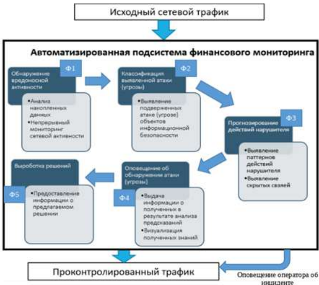
Рисунок 2 - Структурно-функциональная схема аналитического инструмента прогнозирования инцидентов ИБ (автоматизированной подсистемы финансового мониторинга)
