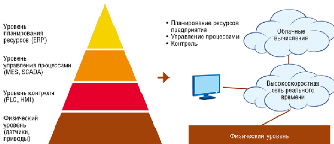
Рисунок 1 - Переход от обычных АСУ ТП к промышленному интернету
