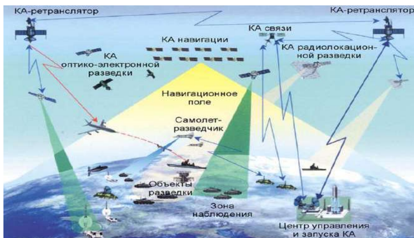
Рисунок 4 - Пример ведения космической радиоэлектронной разведки (во взаимосвязи с космической и сотовой системами связи)
