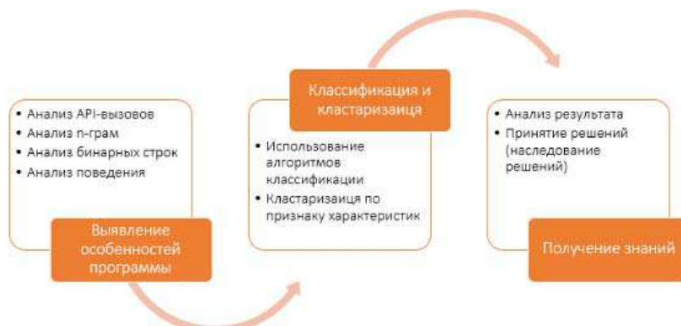
Рисунок 1 - Концептуальная схема применения Data Mining для выявления потенциальных вредоносных ПО
