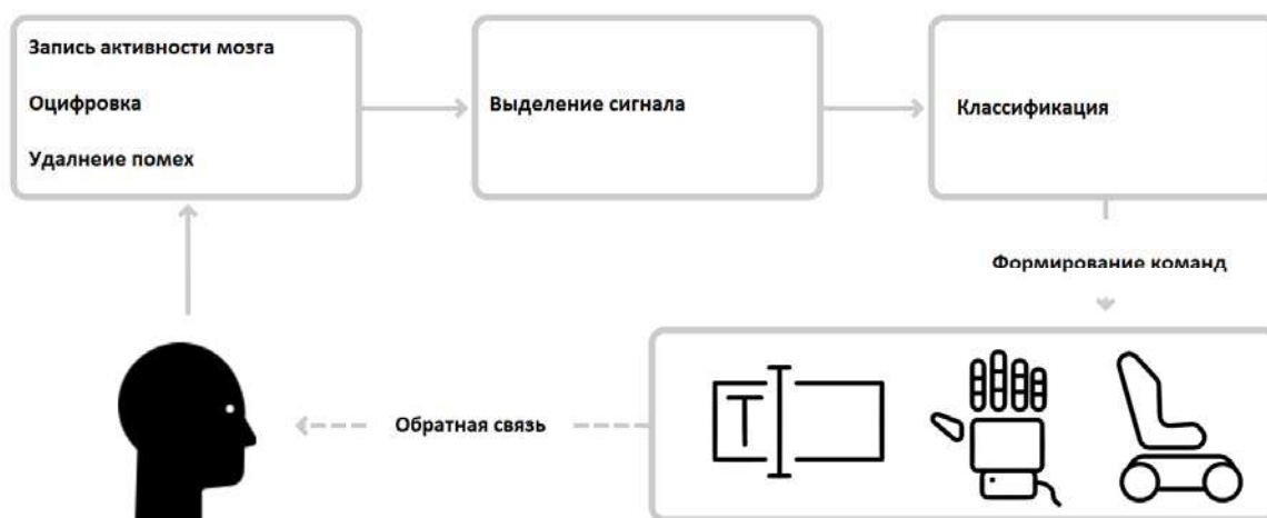
Рисунок 4 – Схема работы нейроинтерфейса, регистрирующего активность мозга
