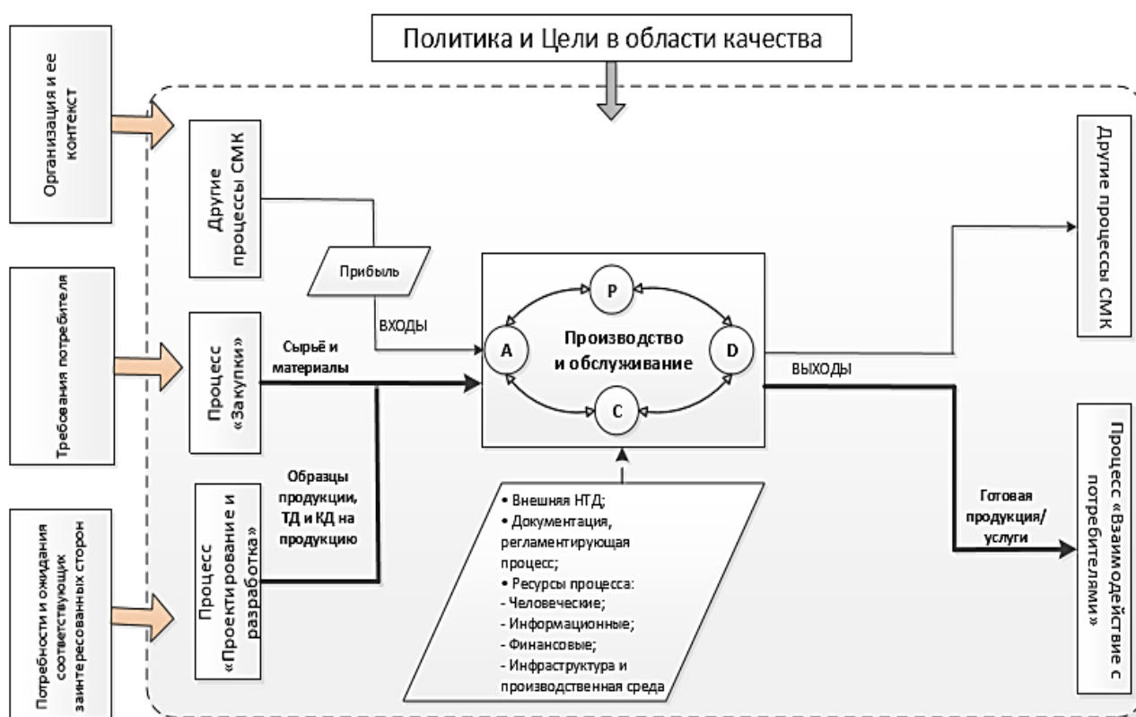
Рисунок 1 – Схема производства продукции, основанная на процессном подходе
