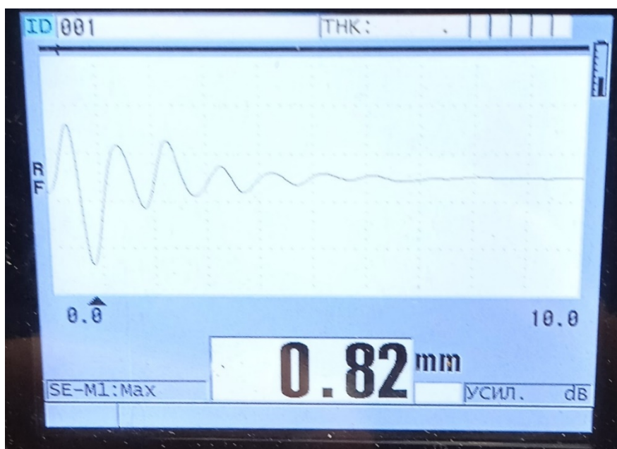
Рисунок 5 – Результаты дефектоскопии третьего образца из углепластика
