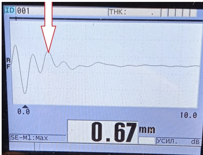
Рисунок 3 – Результаты дефектоскопии первого образца из углепластика
