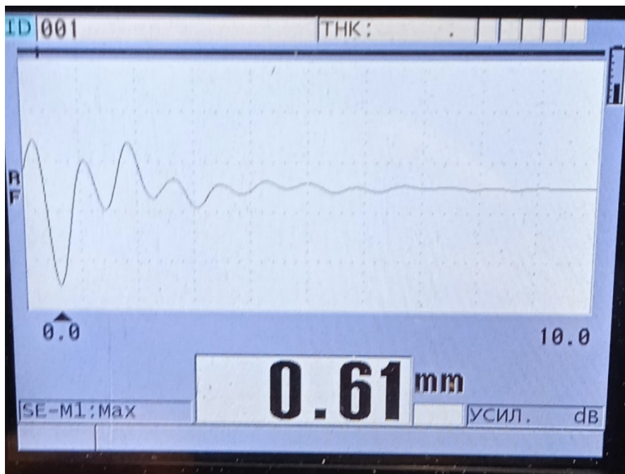
Рисунок 4 – Результаты дефектоскопии второго образца из углепластика
