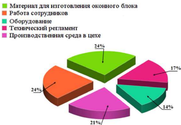
Рисунок 3 – Факторы, влияющие на брак при производстве оконного блока
