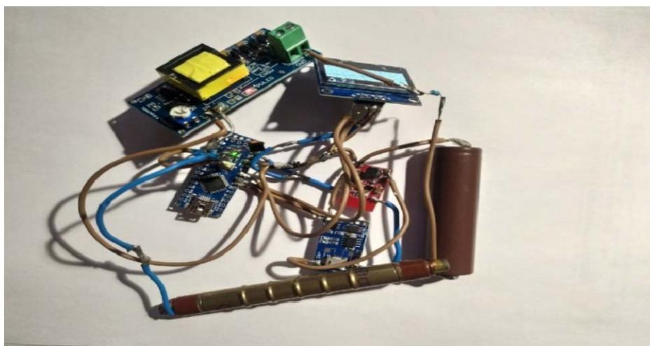
**Рисунок 6 – Собранный дозиметр**
