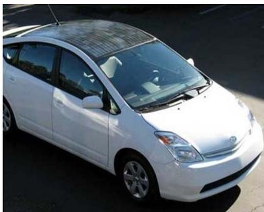
Рисунок 10 – Электромобиль с солнечной батареей
