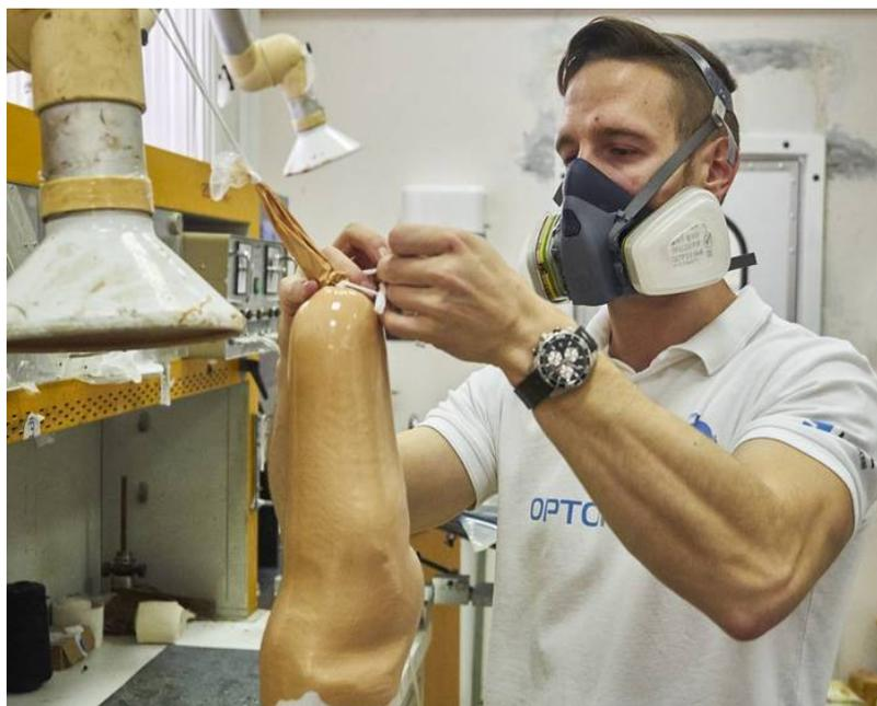
**Рисунок 12 – Изготовление постоянной гильзы**
