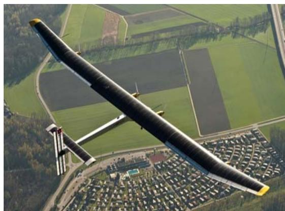
Рисунок 11 – Самолет Solar Impulse, оснащенный солнечной панелью
