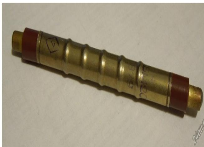
**Рисунок 2 – Газоразрядная трубка**
