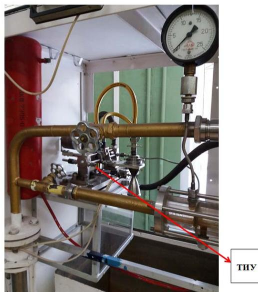
**Рисунок 3 – Тяго-измерительное устройство (ТИУ) на стенде**
