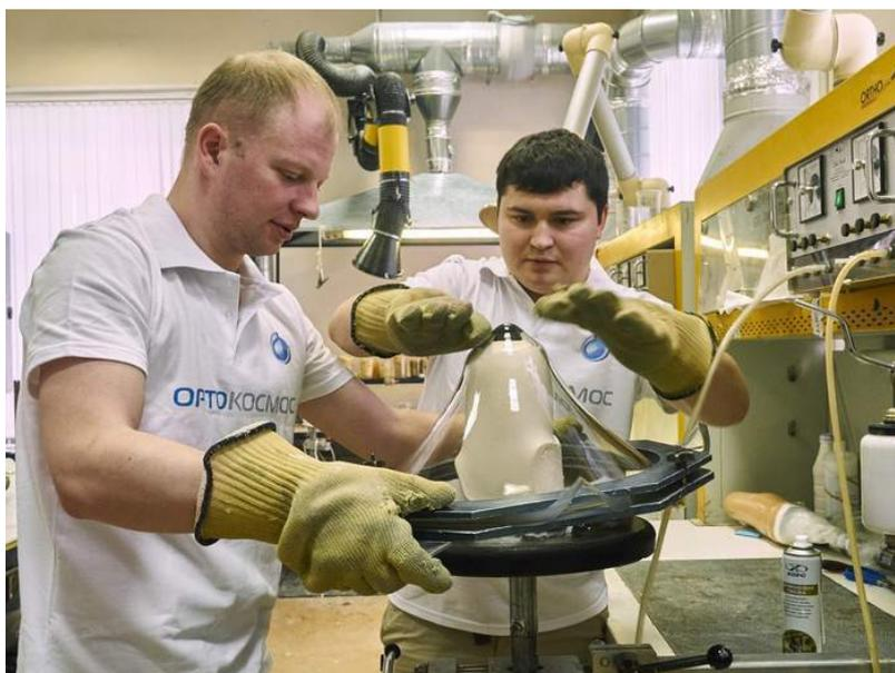
**Рисунок 11 – Изготовление примерочной гильзы**
