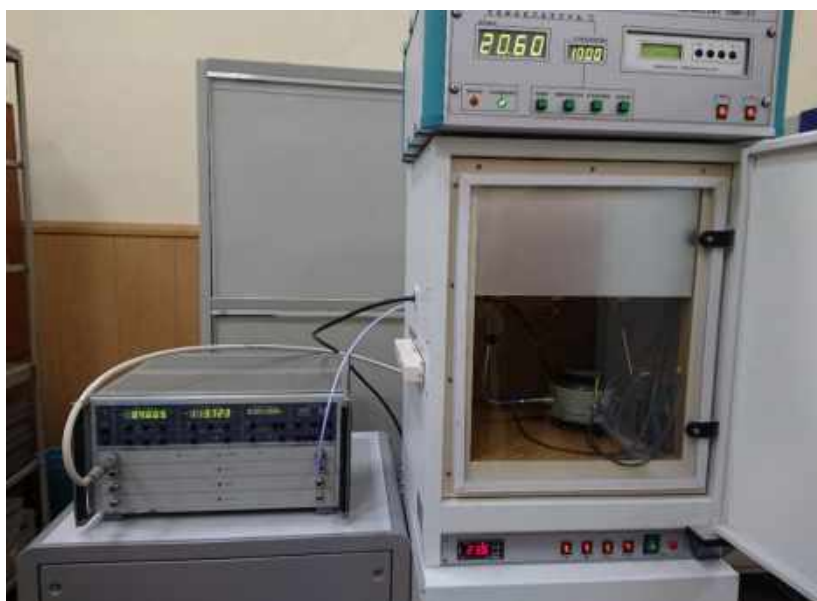
Рисунок 3 – Готовая схема для измерения ослабления ступенчатого аттенюатора Д1-25
