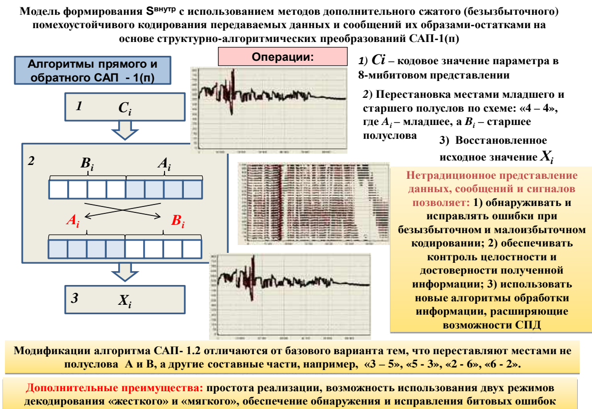
Рисунок 1 – Основные операции предлагаемого алгоритма дополнительного помехоустойчивого кодирования
