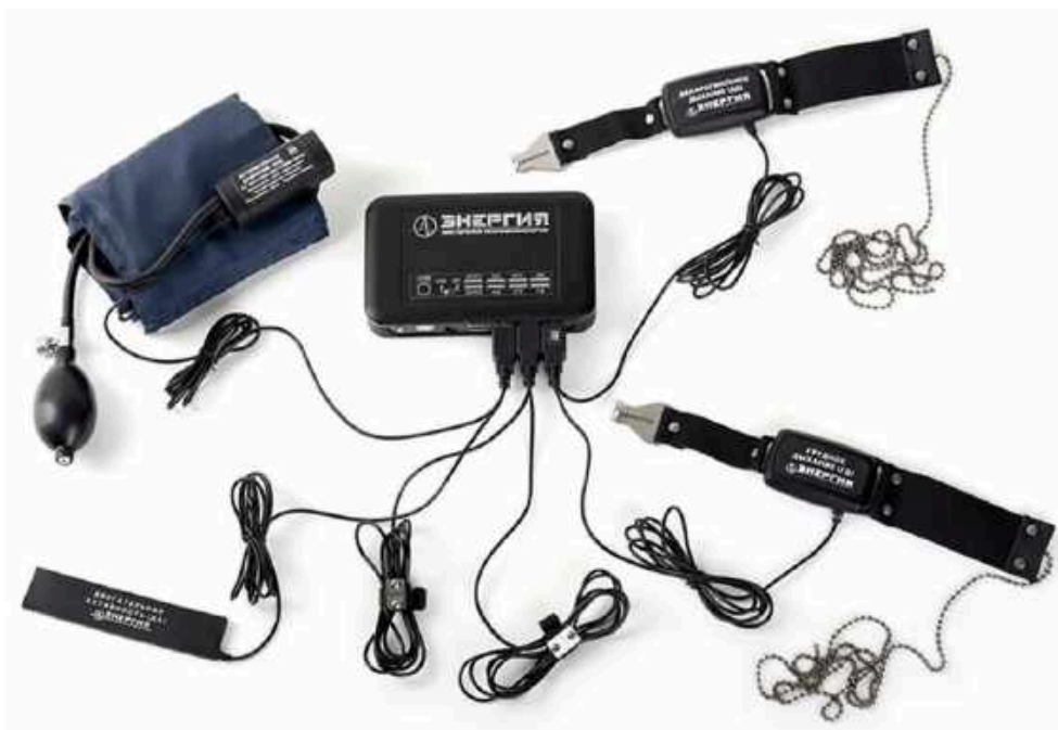
Рисунок 4 – Российский полиграф «Энергия Стационарный», стоимостью 270 тыс руб., включающий в себя 6 датчиков, регистрирующих давление, пульс, частоту сердцебиения и прочие параметры
