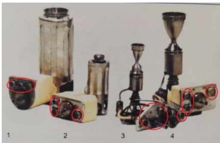
Рисунок 4 – Однокомпонентные ЖРДМТ разработки КБхиммаш
