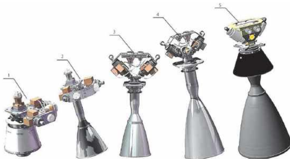
Рисунок 2 – ЖРДМТ разработки КБхиммаш
