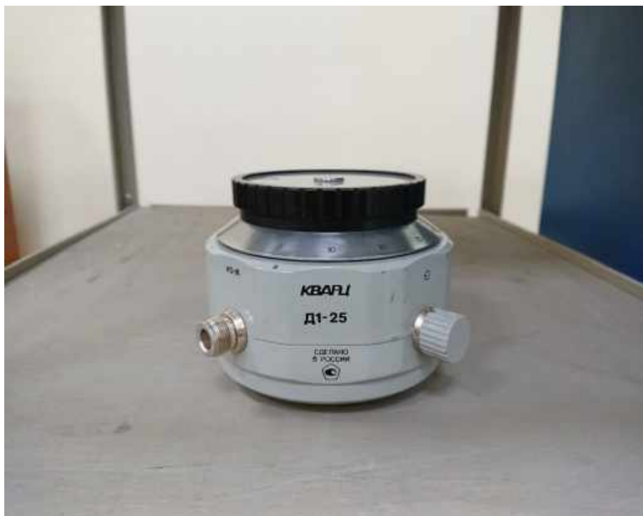
Рисунок 1 – Прибор для измерения ослабления ступенчатый Д1-25
