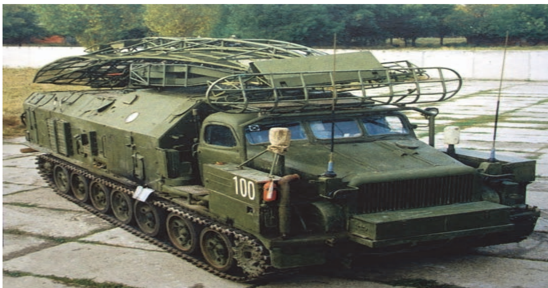
Рисунок 3 – Радиолокационный комплекс П-40А
