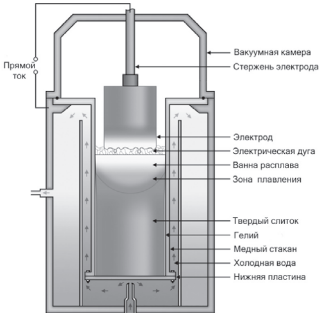
Рисунок 1 – Процесс изготовления ВЭС вакуумно-дуговым переплавом
