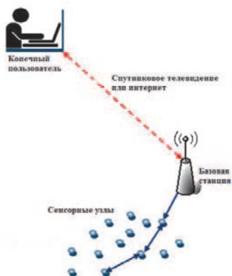
Рисунок 2 – Типичная архитектура БСС
