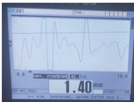
Рисунок 4 – Результаты дефектоскопии образца второй группы
