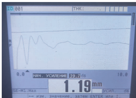
Рисунок 3 – Результаты дефектоскопии образца первой группы
