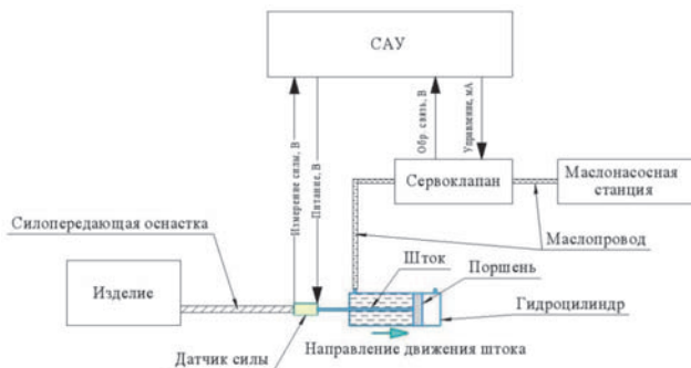
Рисунок 1 – Схема системы силового воздействия
