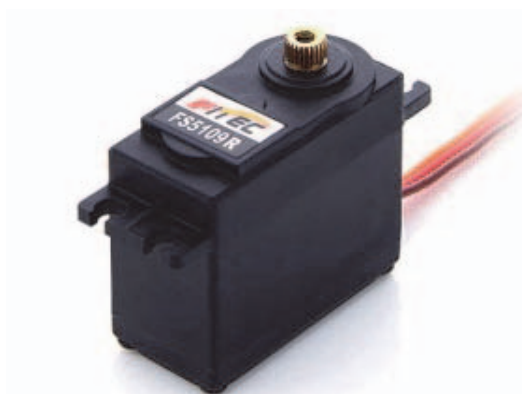
Рисунок 6 – Сервопривод постоянного вращения
