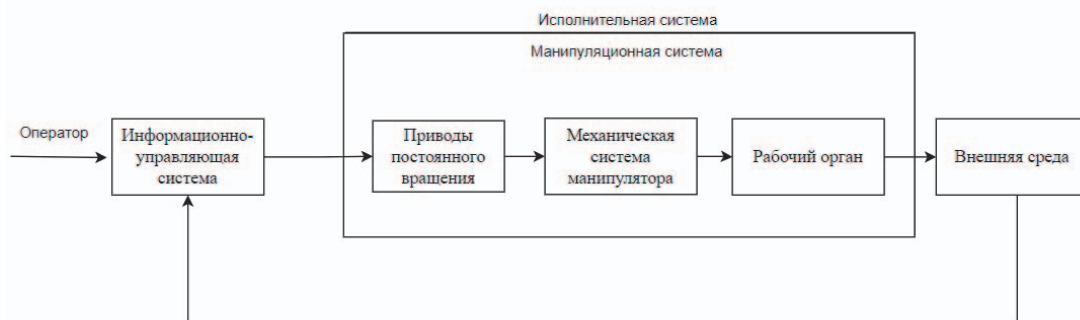
Рисунок 1 – Функциональная схема манипулятора
