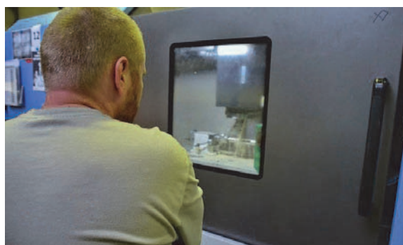
Рисунок 8 – Станок с ЧПУ обрабатывает деталь затворного механизма
