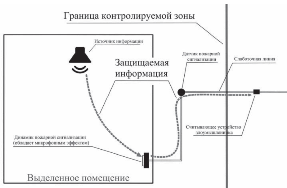
Рисунок 1 – Схема утечки по акустоэлектрическому каналу
