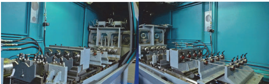
Рисунок 2 – Станок для обработки деталей винтовки
