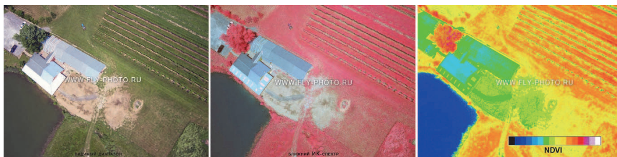
Рисунок 6 – Аэрофотографирование местности в видимом спектре и инфракрасном
