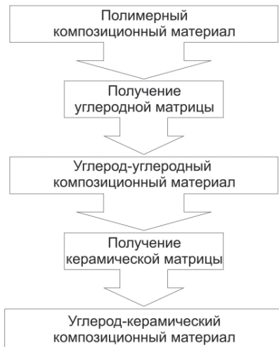
Рисунок 4 – Технологическая схема изготовления углерод-углеродных и углерод-керамических композиционных материалов
