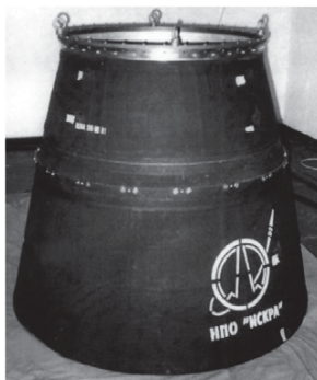
Рисунок 1 – Насадок радиационного охлаждения из УУКМ
