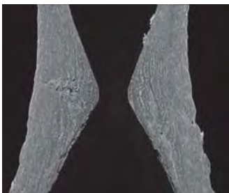
Рисунок 6 - Томография заготовки плетеной камеры сгорания жидкостных ракетных двигателей малой тяги
