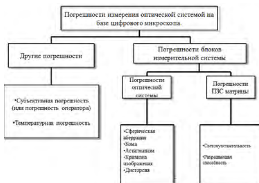
Рисунок 2 - Источники погрешностей оптической измерительной системы на базе цифрового микроскопа
