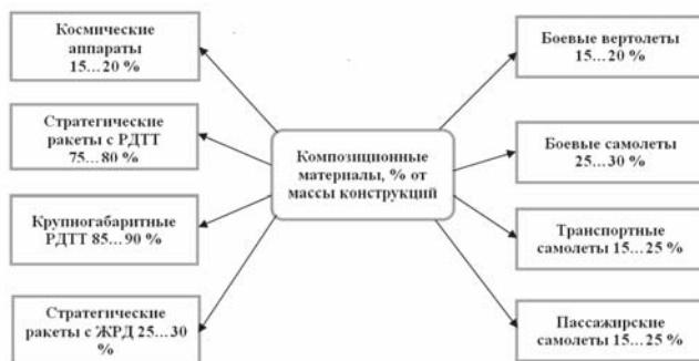
Рисунок 1 – Композиты в ракетной и аэрокосмической технике
