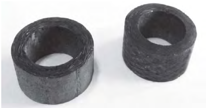
Рисунок 3 - Кольцевые образцы из цилиндрической части камеры сгорания жидкостных ракетных двигателей малой тяги (слева – ткано-выкладочный; справа – плетеный)
