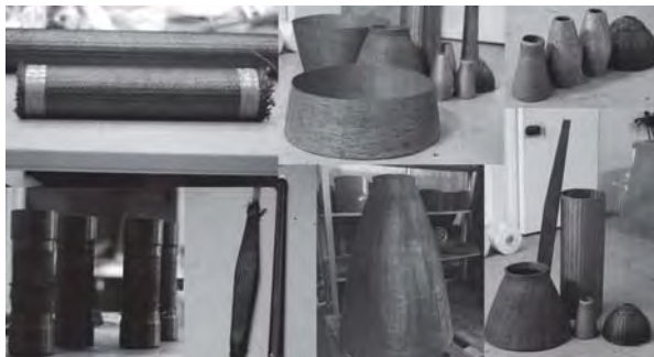
Рисунок 5 – Образцы, изготовленные на радиально-плетельной машине РП128-1-130
