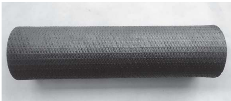
Рисунок 4 – Образец, симулирующий камеру сгорания жидкостного ракетного двигателя малой тяги
