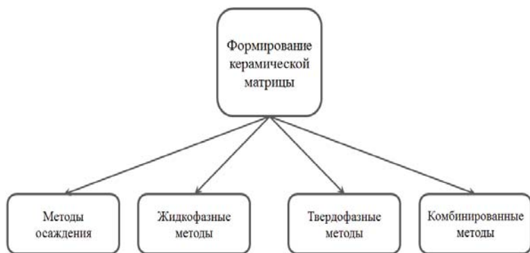
Рисунок 1 – Технологические методы для формирования керамической матрицы
