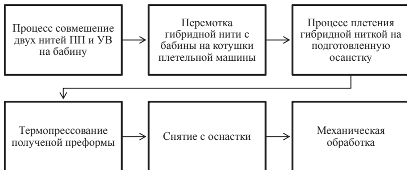
Рисунок 3 – Технологическая схема получения КМ на основе термопластичной матрицы методом контурного плетения
