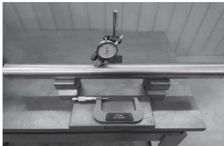
Рисунок 4 – Проверка электрода на биение
