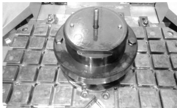
Рисунок 4 - Приспособление для установки обрабатываемой детали
