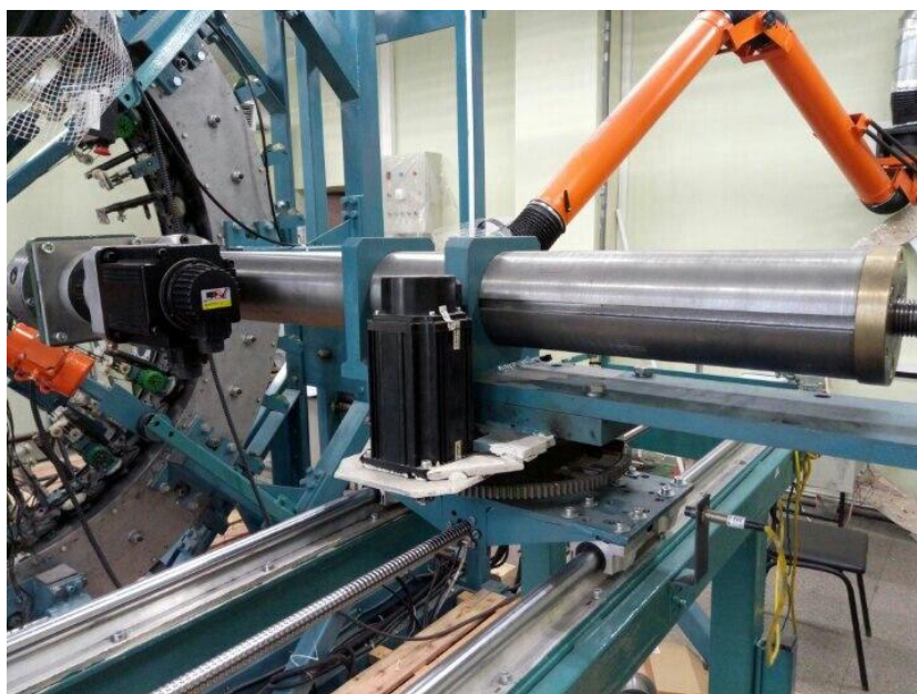
Рисунок 5 – Сервопривод с планетарным редуктором и зубчатой передачей
