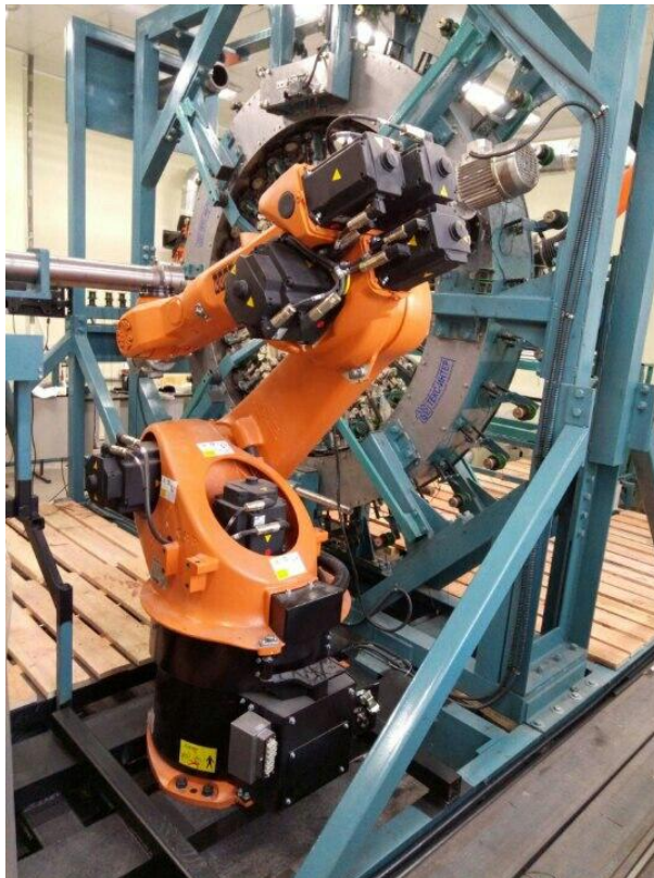
Рисунок 2 – Робот-манипулятор KR 360 FORTEC
