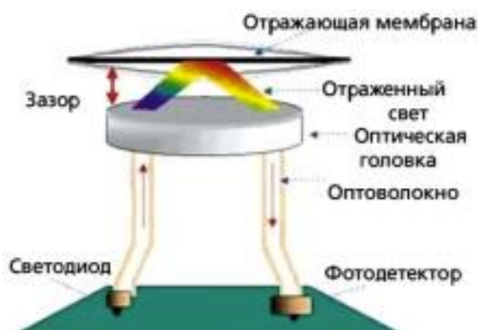
Рисунок 2 – Устройство оптического микрофона
