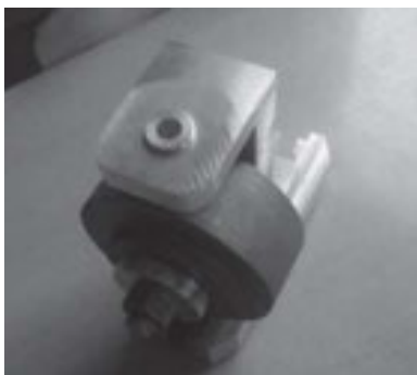
Рисунок 7 - Кондуктор для обработки отверстия во втулке
