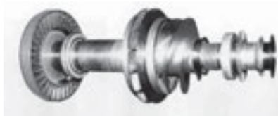
Рисунок 2 – Вал турбонасосного агрегата с турбиной
