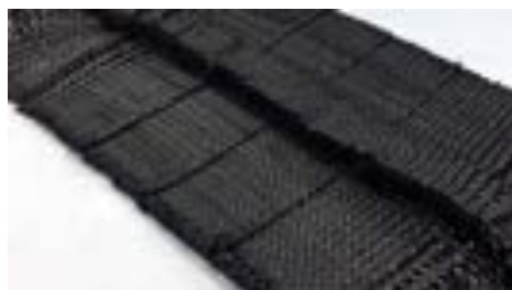
Рисунок 1 – Т-образная углеродная объемно-тканная преформа с поперечным ребром
