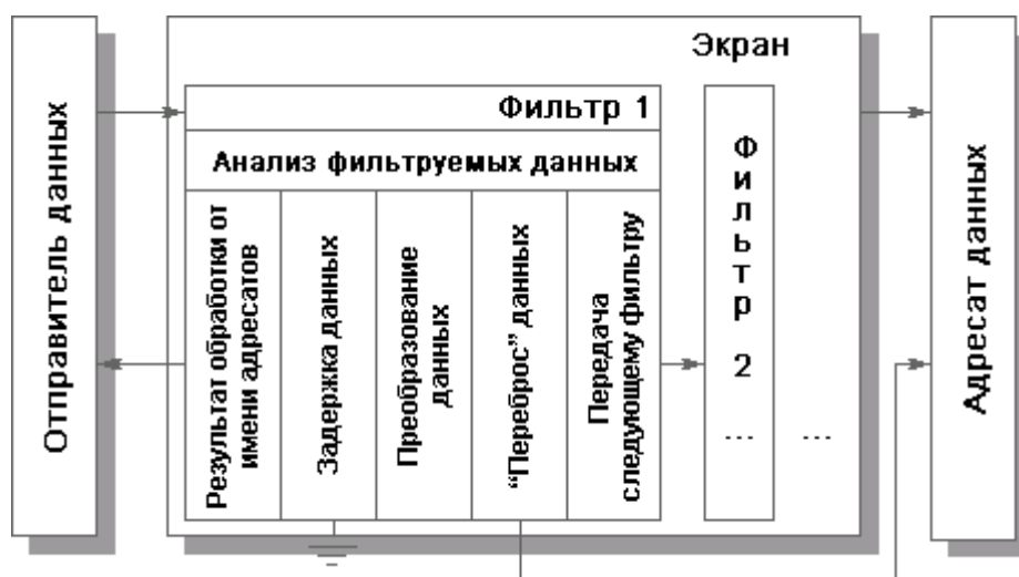
Рисунок 3 – Экран как последовательность фильтров
