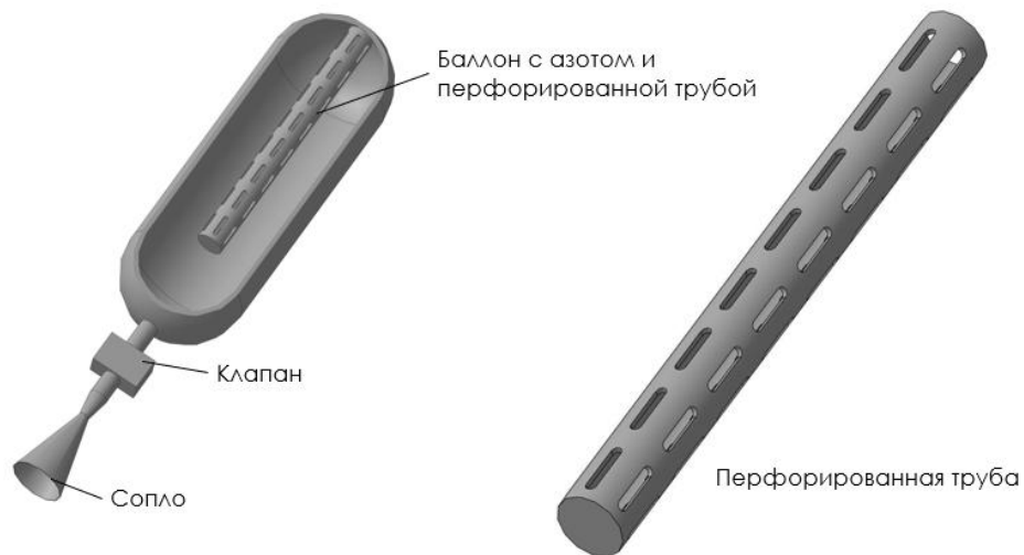
Рисунок 5 - 3d схема усовершенствованного реактивного двигателя на сжатом азоте
