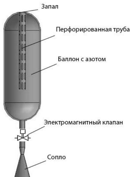
Рисунок 6 - 3d схема реактивного двигателя на сжатом азоте
