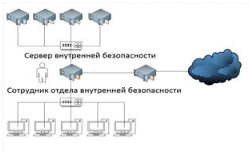
Рисунок 2 - Топология сети, после внедрение сервера внутренней безопасности
