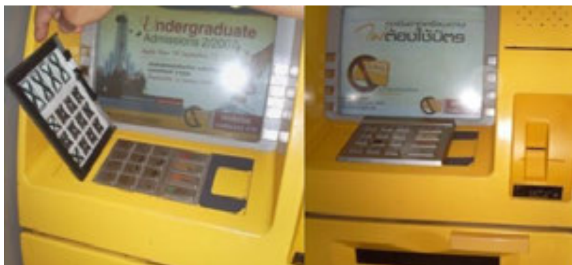
Рисунок 1 - Внешний вид модифицированного банкомата
