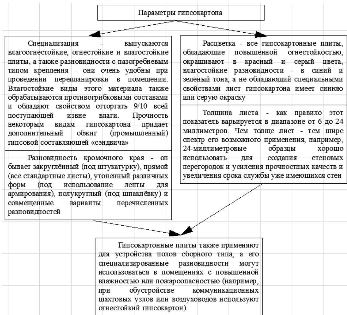
Рисунок 2 - Параметры гипсокартона
