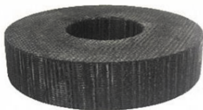
Рисунок 1. Прошита углеродная ткань и материал типа КИМФ
