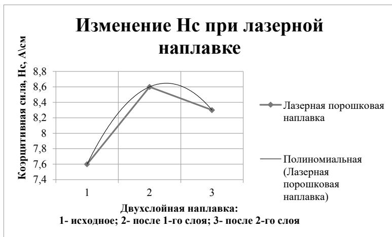
Рисунок 2. Изменение значений коэрцитивной силы H_c металла подложки после многослойной лазерной наплавки
