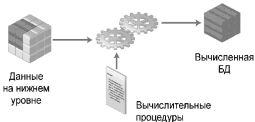
Рисунок 7. Логическая архитектура блочного хранения многомерной информации
