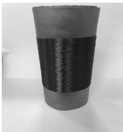
Рисунок 3. Образцы полимерных (А) и керамических (Б) волокон структуры \text{SiCN(O)} . Линейная намотка
