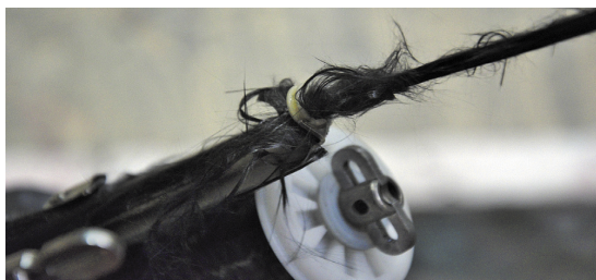
Рисунок 1. Нить с большим числом оборванных филаментов [2]
