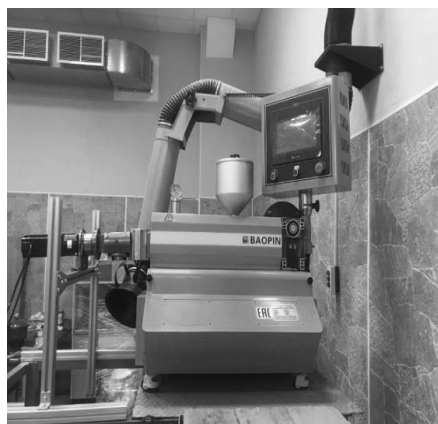
Рисунок 2. Внешний вид опытно–промышленной установки формирования полимерных волокон из расплава полимерных прекурсоров: А–вид спереди, Б–вид сзади
