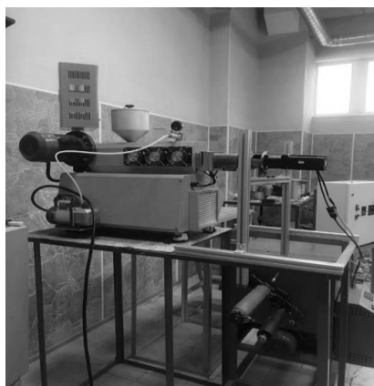
Рисунок 2. Внешний вид опытно–промышленной установки формирования полимерных волокон из расплава полимерных прекурсоров: А–вид спереди, Б–вид сзади
