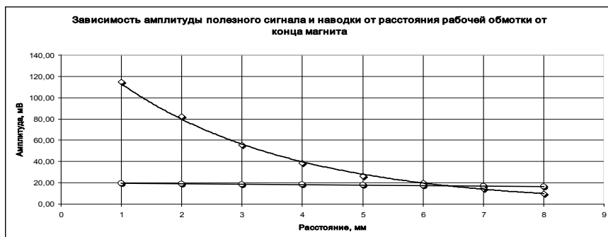
Рисунок 4. Зависимость амплитуды полезного сигнала и наводки от расстояния рабочей обмотки до конца магнита
