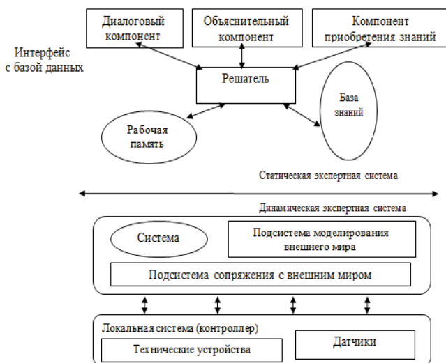
Рисунок 3. Архитектура статических и динамических экспертных систем
