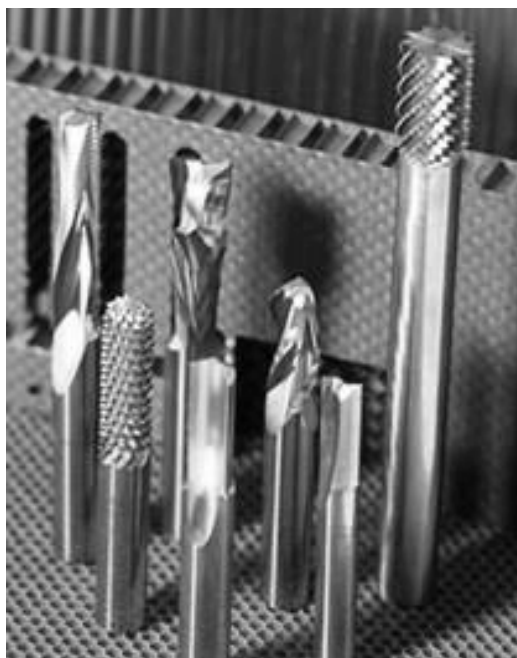
Рисунок 4. Примеры имеющегося инструмента для механической обработки композиционного материала
