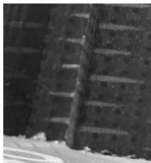
Рисунок 1. Примеры дефектов граней, возникающих в результате механической обработки
