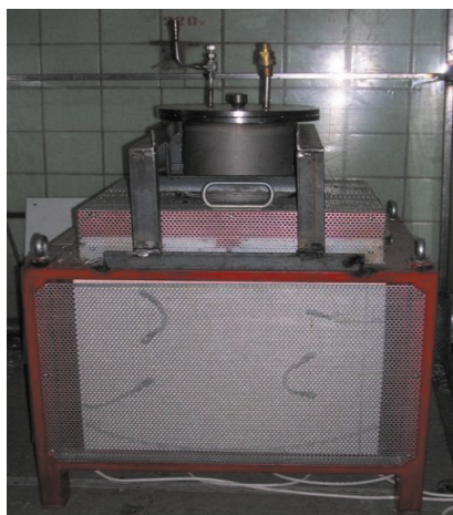
Рисунок 1. Лабораторная установка для проведения PIP-процессов в АО «Композит»
