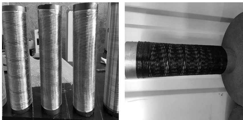
Рисунок 4. Образцы полимерных (А) и керамических (Б) волокон структуры SiCN(O). Крестовая намотка
