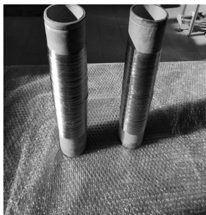
Рисунок 3. Образцы полимерных (А) и керамических (Б) волокон структуры \text{SiCN(O)} . Линейная намотка
