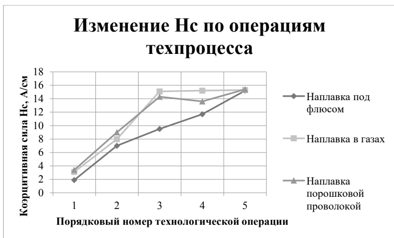
Рисунок 3. Зависимость измеренных значений коэрцитивной силы H_c металла подложки после однослойной наплавки дуговыми методами
