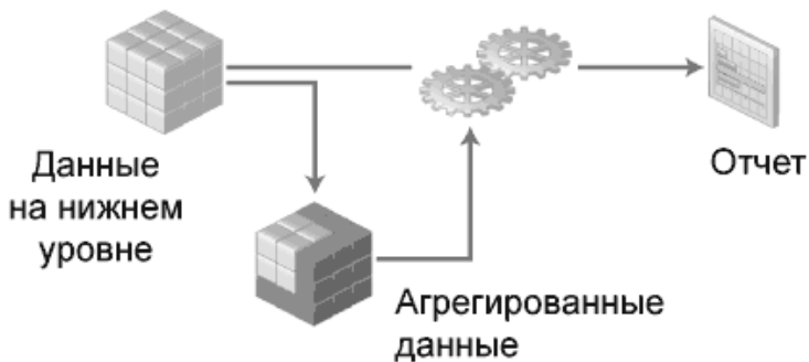
Рисунок 8. Логическая архитектура агрегатного хранения многомерной информации
