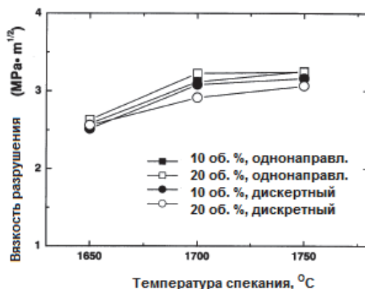
Рисунок 5 – Вязкость разрушения SiC-композитов, армированных дискретными SiC-волокнами при горячем прессовании
