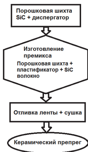
Рисунок 2 – Схема изготовления керамического препрега методом литья
