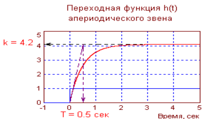
Рис. 2.3. Переходная функция аperiodического звена
